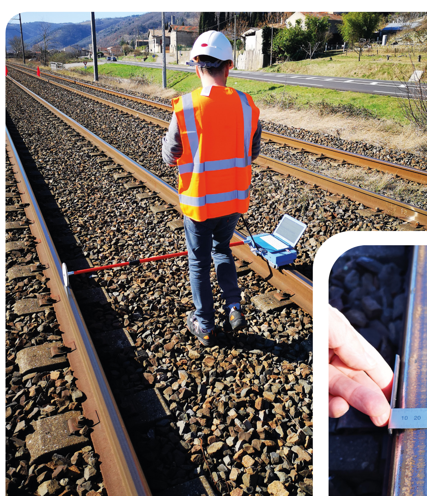
Mesure des défauts de surface de rails à l'origine du bruit de roulement
