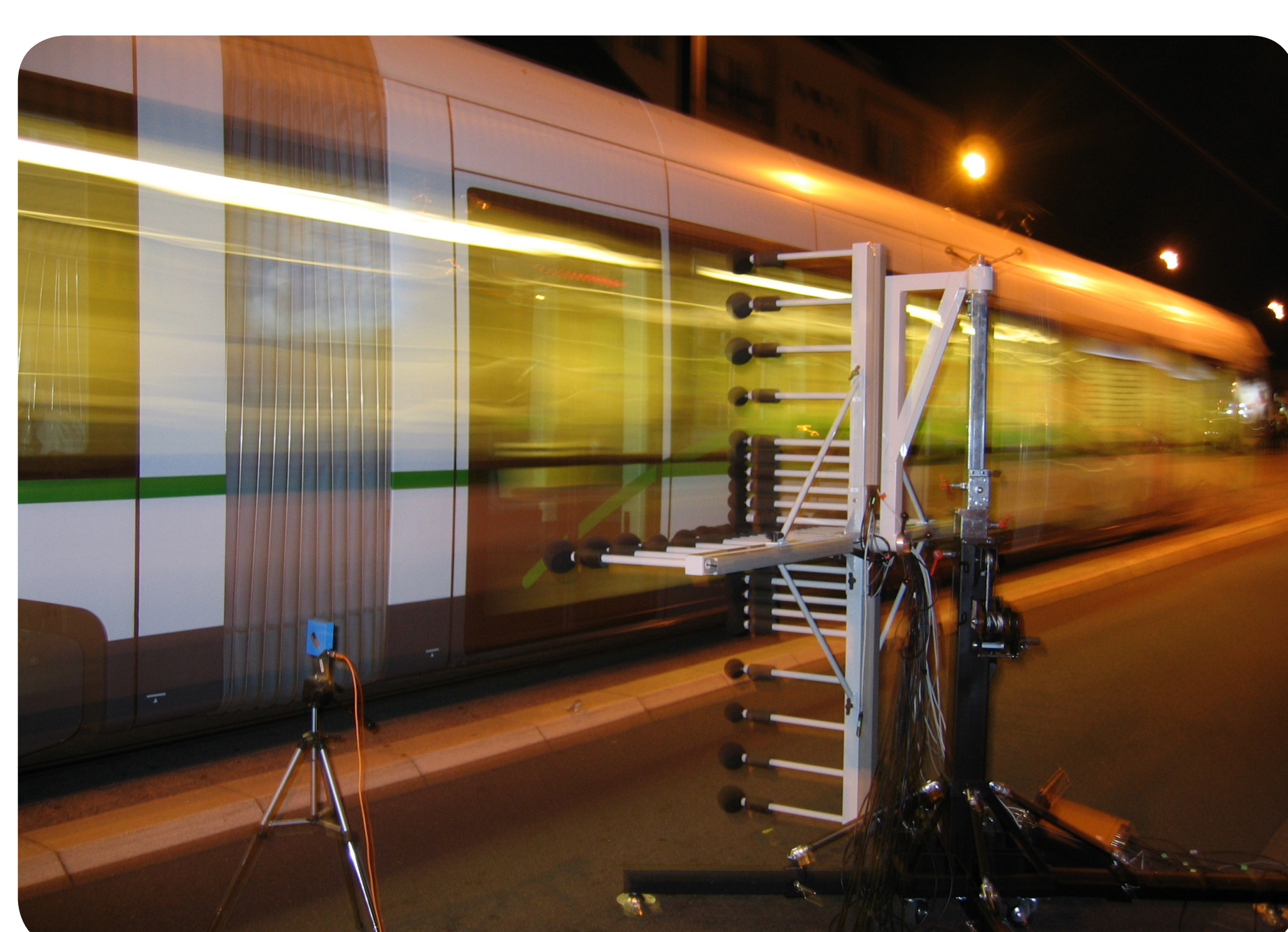
Localisation et caractérisation des sources de bruit au passage à l'aide d'une antenne microphonique
