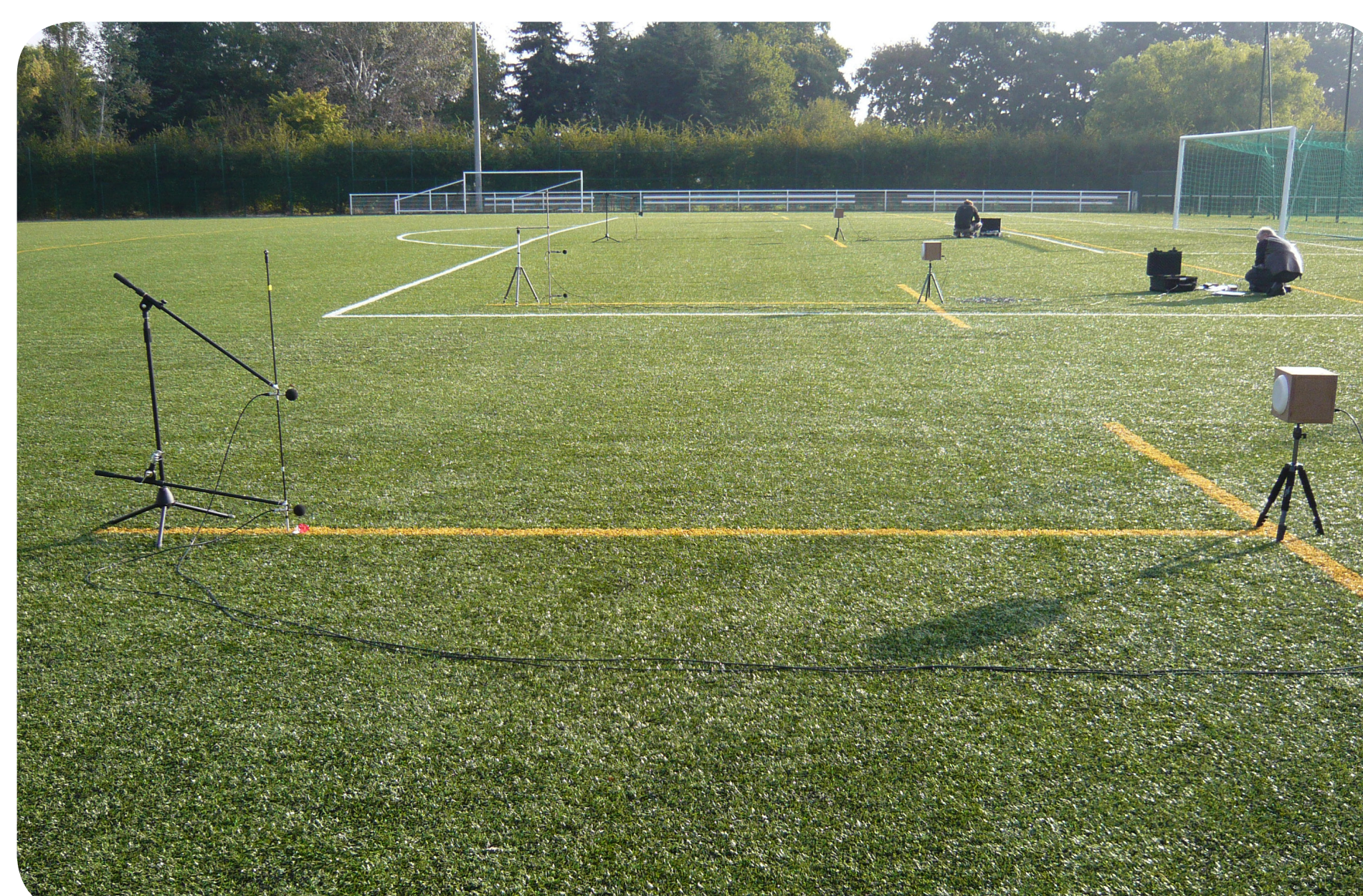
Essais croisés de qualification du système de mesure d'impédance MIAME, reposant sur la fonction de transfert entre les pressions mesurées au niveau de deux microphones (Projet PLUME)
