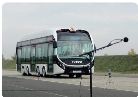
Mesure de l'émission sonore d'un bus électrique en conditions réelles (Projet ELISup)
