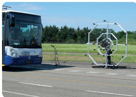
Caractérisation des sources de bruit d'un bus hybride au moyen d'une antenne de 57 microphones (Projet ELISip)
