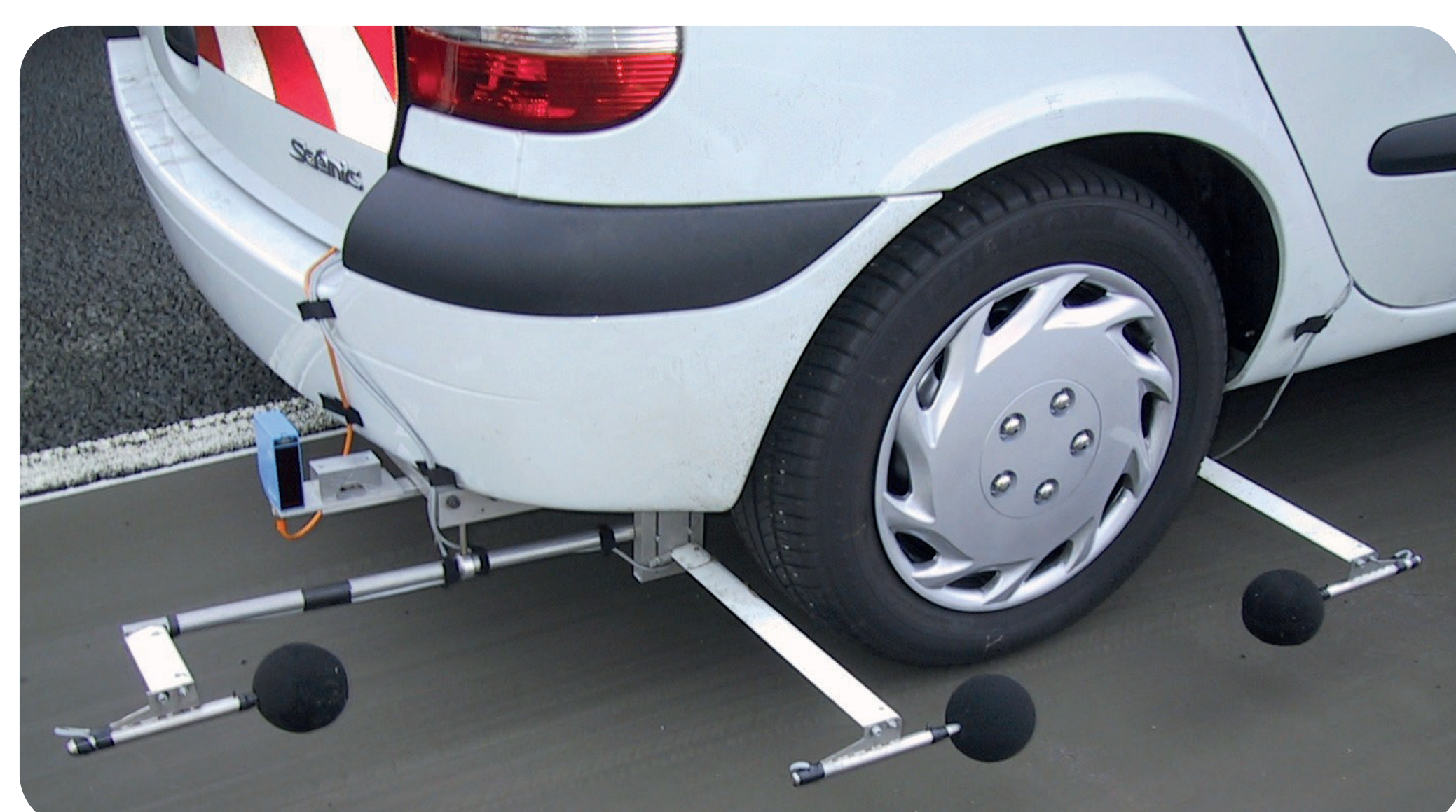
Méthode de mesure en continu du bruit de roulement par système CPX embarqué sur véhicule léger
