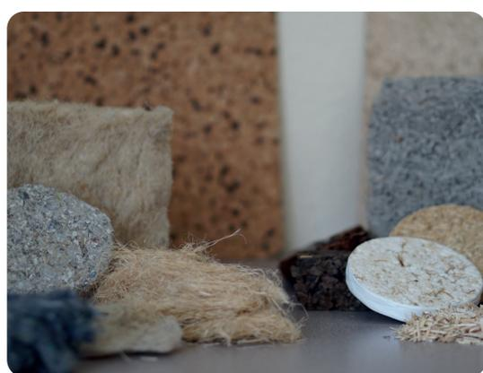
Quelques exemples de matériaux biosourcés, à base de fibres et particules végétales.
