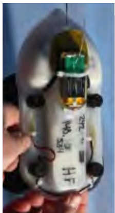
La balise multi-capteurs est déployée par une perche manuelle sur le dos d'une baleine à bosse et maintenue sur le dos de l'animal de manière non invasive au moyen de ventouses en silicone. La balise contient différents capteurs (hydrophones, capteur de pression, magnétomètres et accéléromètres 3D, GPS) permettant d'enregistrer les sons produits et reçus par les animaux, et leurs mouvements.
