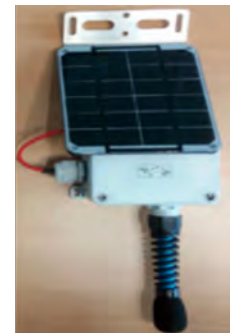
Capteur "nœud", alimenté via un panneau solaire et déployé sur des candélabres dans le cadre du projet CENSE
