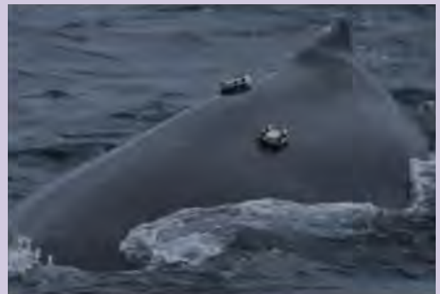
La balise multi-capteurs est déployée par une perche manuelle sur le dos d'une baleine à bosse et maintenue sur le dos de l'animal de manière non invasive au moyen de ventouses en silicone. La balise contient différents capteurs (hydrophones, capteur de pression, magnétomètres et accéléromètres 3D, GPS) permettant d'enregistrer les sons produits et reçus par les animaux, et leurs mouvements.
