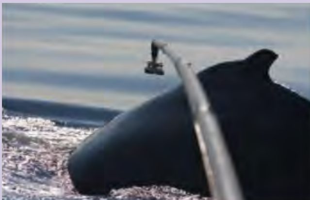
La balise multi-capteurs est déployée par une perche manuelle sur le dos d'une baleine à bosse et maintenue sur le dos de l'animal de manière non invasive au moyen de ventouses en silicone. La balise contient différents capteurs (hydrophones, capteur de pression, magnétomètres et accéléromètres 3D, GPS) permettant d'enregistrer les sons produits et reçus par les animaux, et leurs mouvements.
